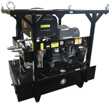
Güç Üniteleri PPP-5000 ve PPP-3000 ; PTM-5000 ve PTM-3000 Delme Makinaları için Güç Üretmektedir
